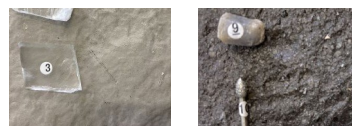
左のサイディングは“3”でキズが付きましたが、右の外壁タイルは“10”でもキズが付きませんでした。* 当社試験
